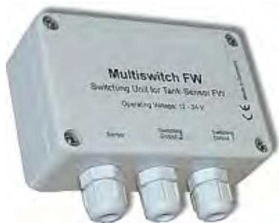
Der separate 3. Ausgang entspricht den Forderungen der NFPA / USA und ist werksseitig als Alarm-Ausgang fest auf 33% eingestellt. Er gibt bei Pegelunterschreitung ein zeitbegrenztes Alarmsignal (Dauer max. 1 Minute) aus.
